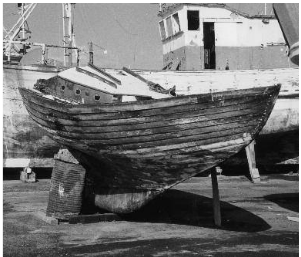
Dieses Motiv fand Jochen Weber, Flotte Essen, auf Gran Canaria. Der schiefe Kajütaufbau kommt vom gebrochenen Decksbalken.
